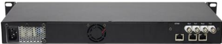
Modelo con conectores BNC para 2 enlaces E1/T1
